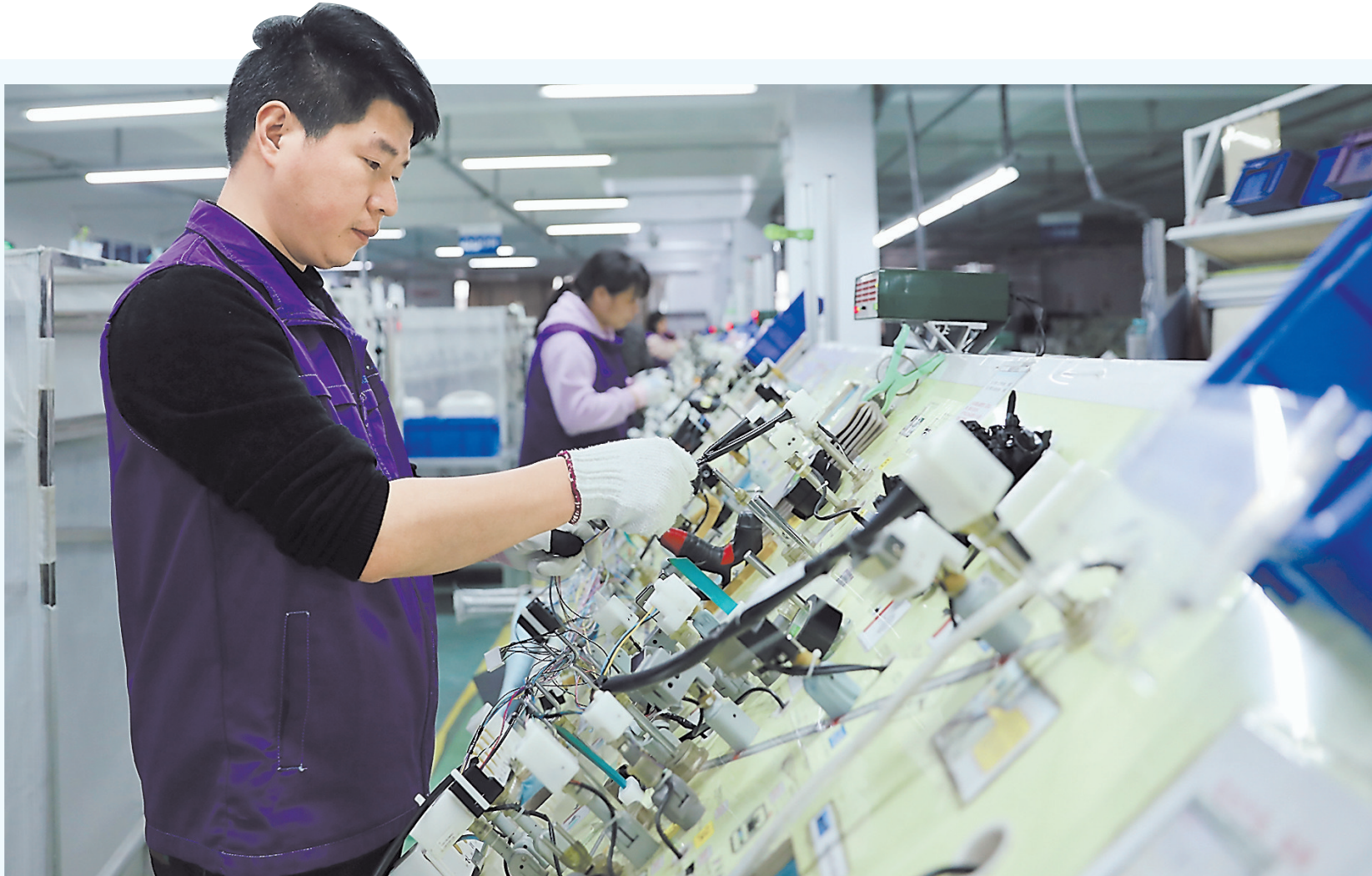
近日,在位于建瓯市城东工业区的建瓯源光电有限公司,工人在生产车间流水线上忙碌。据了解,该公司是世界500强企业住友电装的生产基地之一、建瓯市重点招商引资项目,主要生产车身线、车门线、引擎线等汽车线束,年产值达亿元。 黄杰敏 摄
