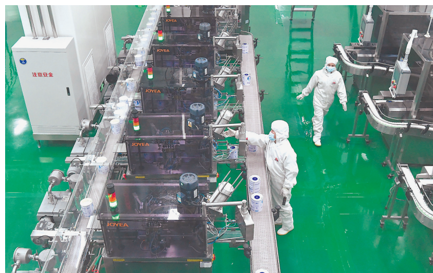
13日,在建宁县福建明一生态营养品有限公司生产车间内,技术人员在巡视自动化生产线。目前,该公司已建成全自动干、湿法乳粉生产线6条,可年产2.5万吨婴幼儿配方奶粉。
