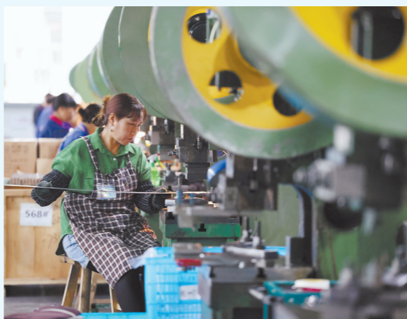
工人在操作冲床加工配件。
