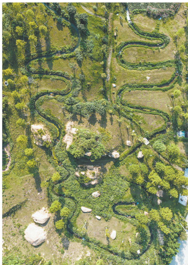
全岛尾水沿着S形的槽沟和水池往下流淌,让水进一步净化。
