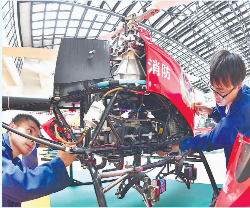
清航装备总装车间内,技术人员在组装“星曜一号”。
