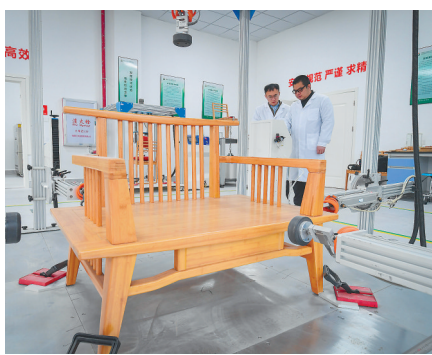
福建省竹制品公共检测平台做竹沙发综合测试。 魏兴谷 摄
