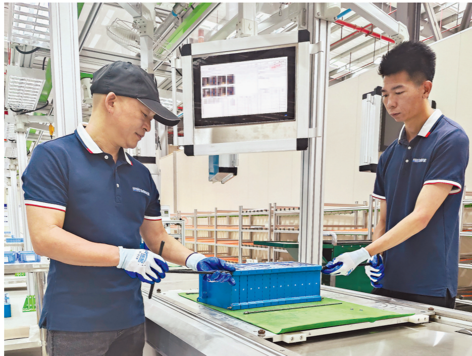
工人在拆解电池模组。
