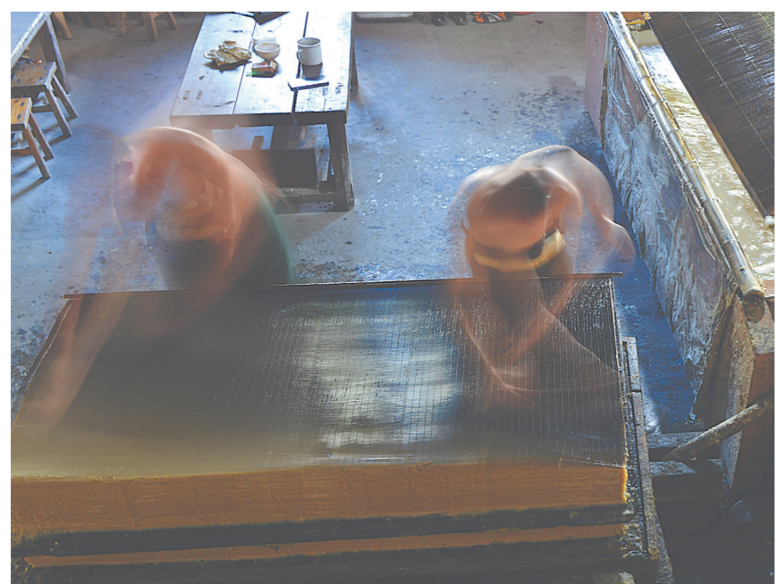
两名工人协调配合进行抄纸作业。用细密的竹帘,荡浆入帘,提起倒扣在榨床上,就分离出一张湿纸。
