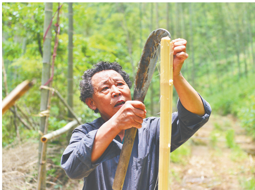
刘仰根将嫩毛竹砍成2米长的竹筒,剥去外层绿皮,再剖成3厘米宽的竹条。
