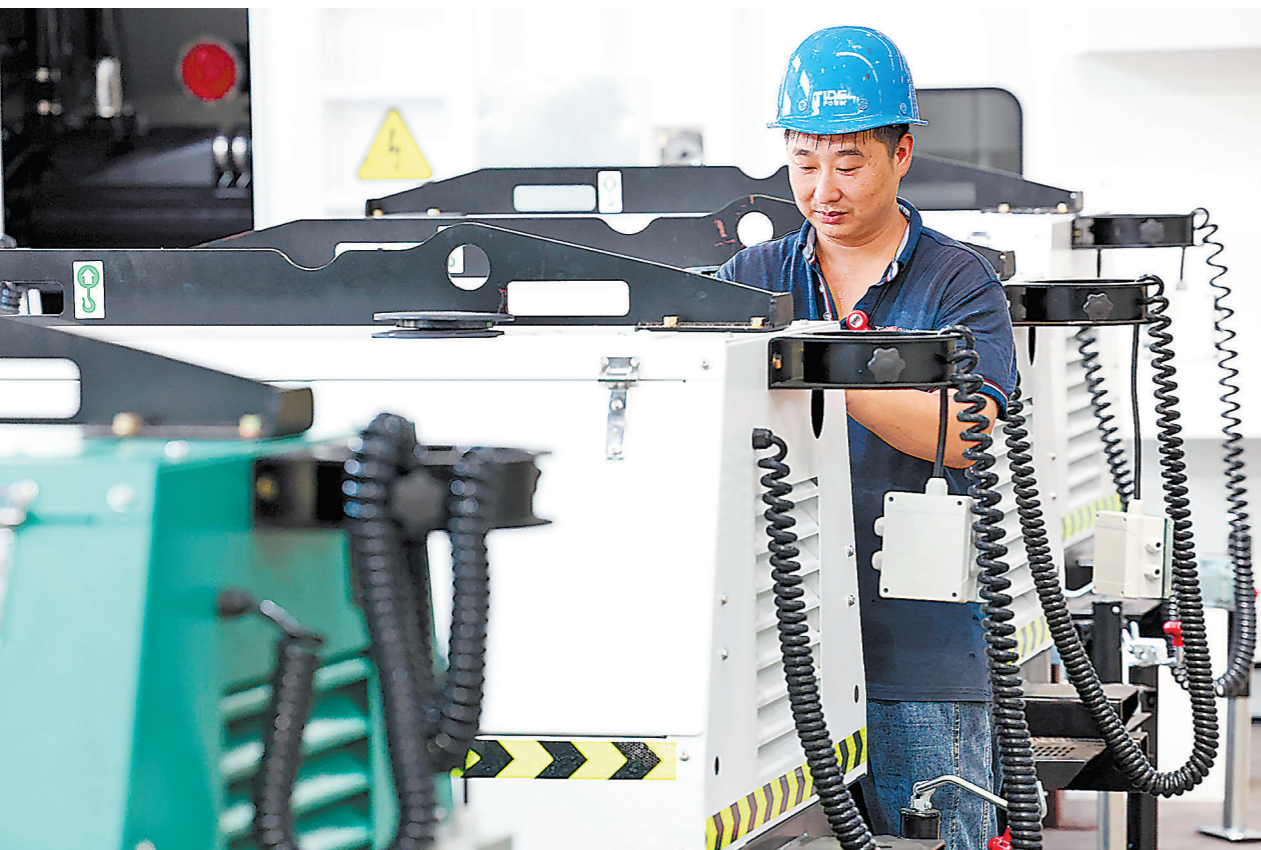
19日,在位于福州市仓山区的港资企业福建科泰德电力设备有限公司生产车间,工人在赶制海外订单。福建外资经济活跃,香港是我省第一大外资来源地。近年来,仓山区不断优化营商环境,用好活法各项惠企政策,使港资企业“轻装前行”,助力经济高质量发展。图为工人在装配发电机组。 王旺旺 摄
