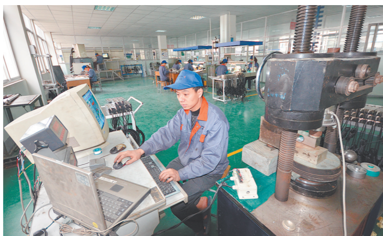
锐马电气车间内,工人在对传感器进行参数校正。(资料照片)
