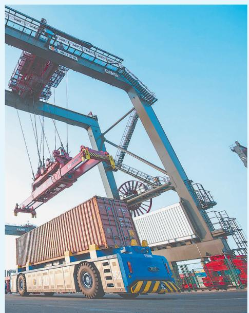
厦门港远海码头的AGV小车正在和龙门吊配合进行装卸。
