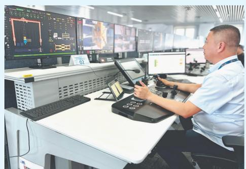
在远程控制室里,司机面对多个显示屏,熟练地通过操纵杆与按键掌控着码头龙门吊的移动与起降。
