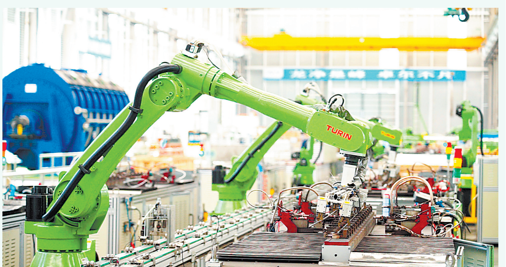
近日,在龙岩中心城市北部新城龙净智慧环保产业园电除尘高精智造车间,机械臂正精准操作针刺线生产系统。全自动上料、焊接,自动检测、打包装箱,车间实现从人工到机器人的生产模式转换。近年来,龙岩市新罗区出台一系列政策,助力“专精特新”企业快速成长。目前,新罗区共有 25 家省创新型中小企业,31 家省级“专精特新”中小企业、11 家国家级专精特新“小巨人”企业。
