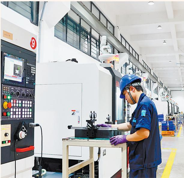
恒而达公司工作人员在进行滑块研磨后检测。(恒而达公司供图)
