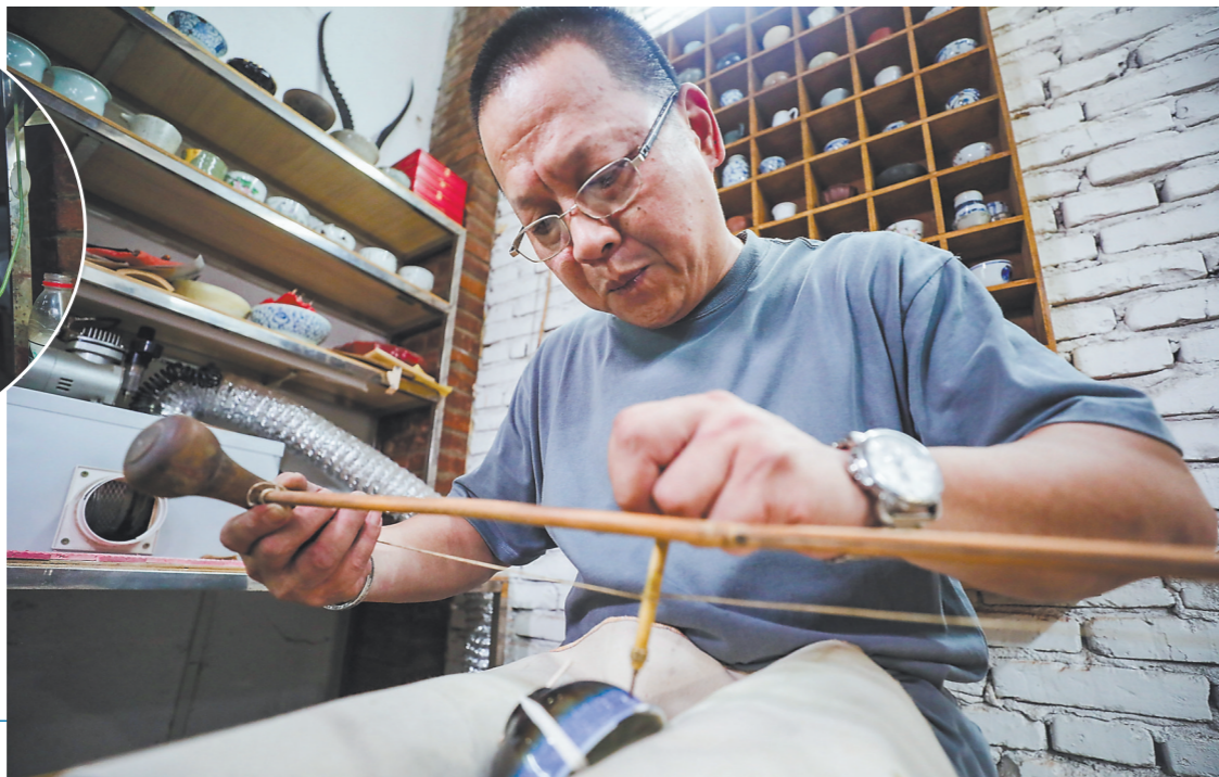
▲陈志敏在瓷器上钻孔。
