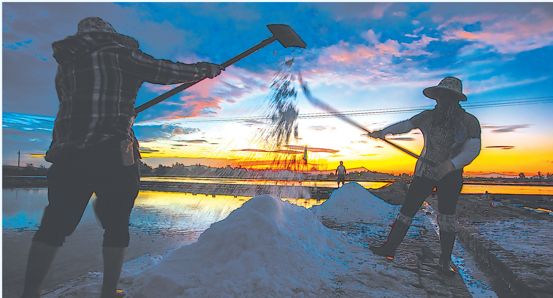
临近傍晚,盐工将扒出的盐堆到田坎上,使其尽快沥干卤水。
