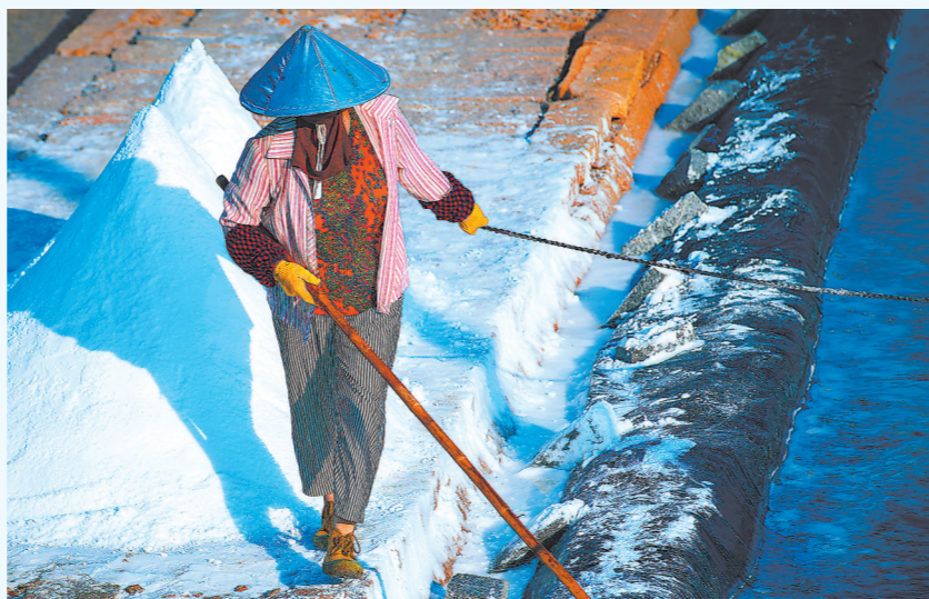
用绳子反复搅拌“拉盐花”,以此来控制盐的结晶细度。
