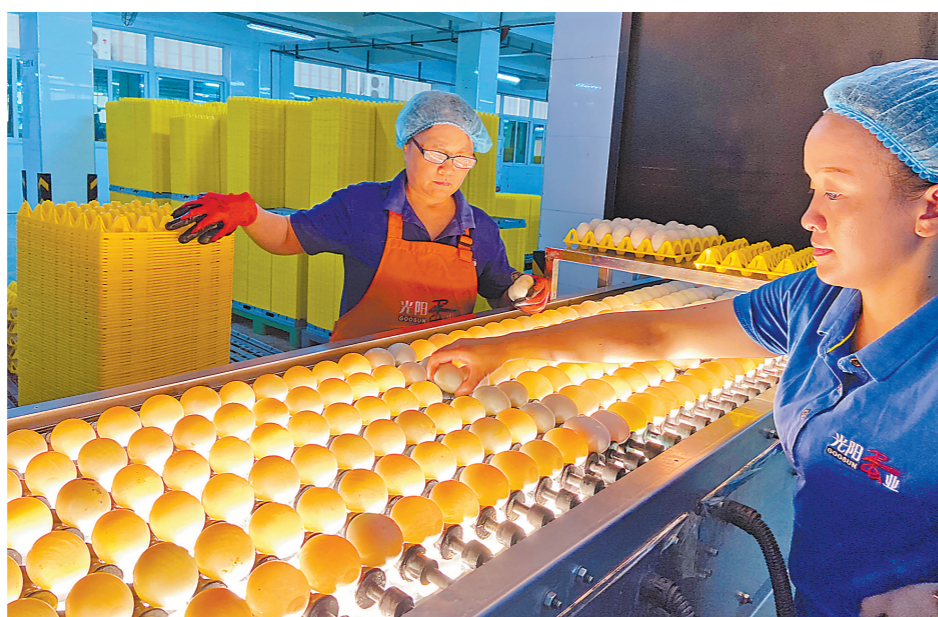
在光阳蛋业位于福清的蛋加工自动生产车间,工人为机器“打辅助”,找出生产线上的破损蛋。
