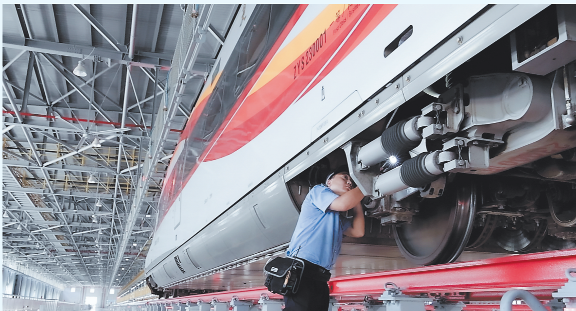
福州南动车二所里,动车组机械师在检修智能复兴号动车组走行部。(福州动车段供图)
