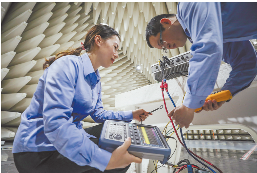
科华电磁兼容实验室内，技术员在检测自主研发的光伏并网逆变器。 郑文典 摄
