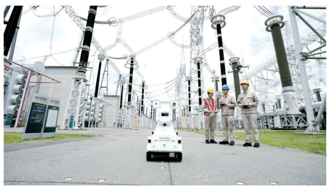
国网福建电力员工应用无人机和机器人联合巡检1000千伏特高压变电站。
