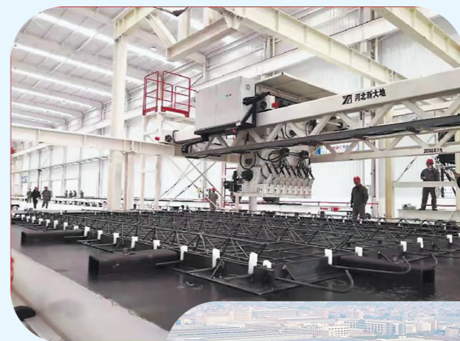
禹澄的发明专利五代产品螺旋布料机,能够进行遥控推送。
