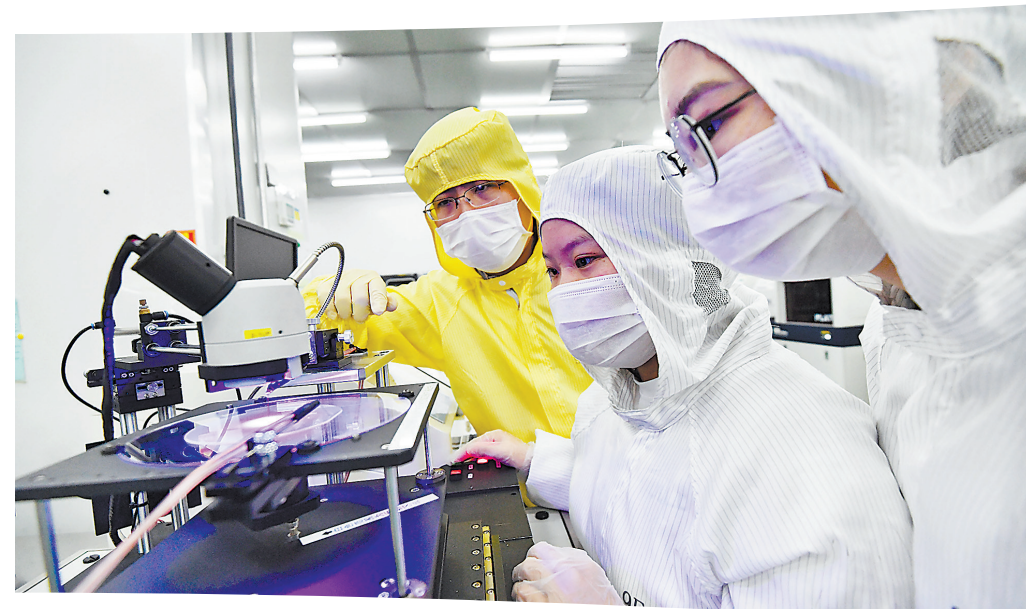
位于福州高新区的兆元光电二期车间内,工人正在LED外延片、芯片生产线上作业。 林辉 摄
