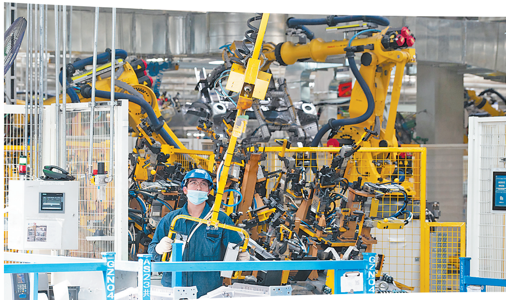
在上汽宁德基地,机器人设备在流水线上焊接车身。 本报记者 王毅 摄
