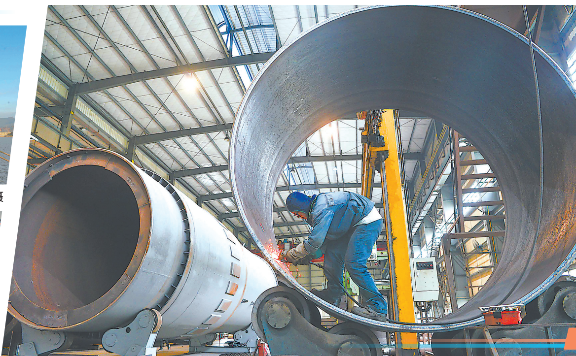
国内最大的压气机械生产厂家之一——沙县金沙园的厦工(三明)重型机器有限公司加工车间内,工人正在打磨非标件壳体。 游庆辉 许琰 摄
