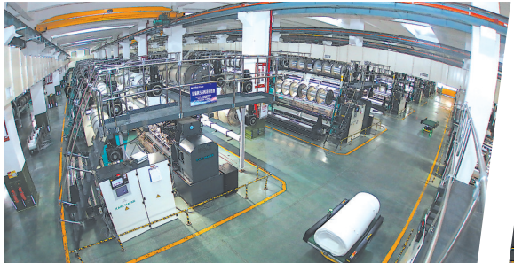
在晋江华宇铮集团智能化车间,AGV物流机器人在搬运经编成品。 赖进财 摄
