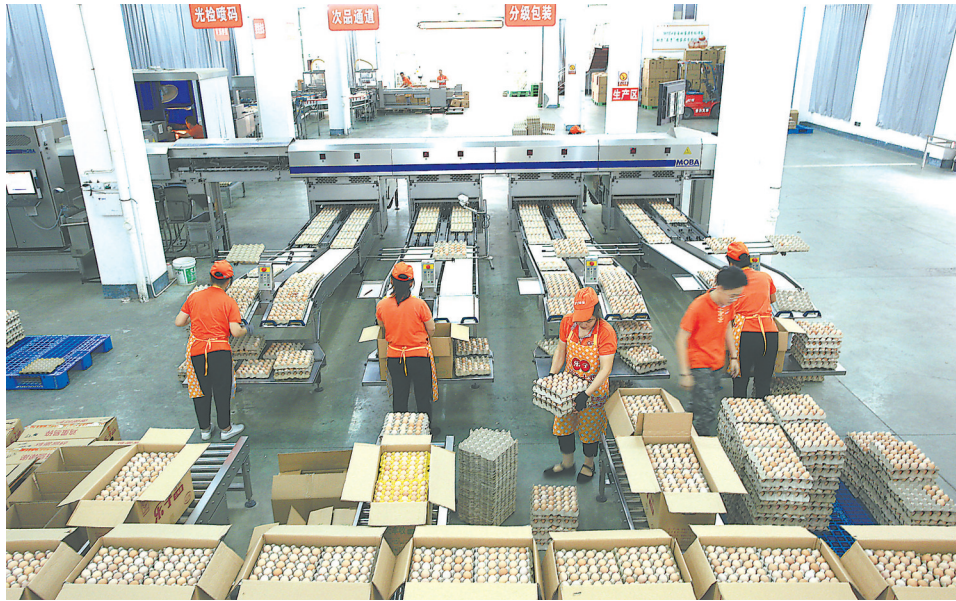
位于三明市沙县区的福建乐子食品科技有限公司的鸡蛋分拣车间里,全自动蛋品分级设备正在运转。
