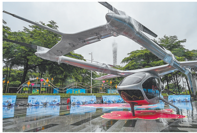
近日,一场低空航展在广州天德广场举行,十余架明星eVTOL(电动垂直起降飞行器)机型集中亮相。本次航展是国内低空经济相关企业助力推动广州成为国内首个载人飞行商业化运营城市的积极行动。图为大型eVTOL载人航空器盛世龙,该机5座设计,最大起飞重量2吨,速度可超200公里/小时。 新华社
