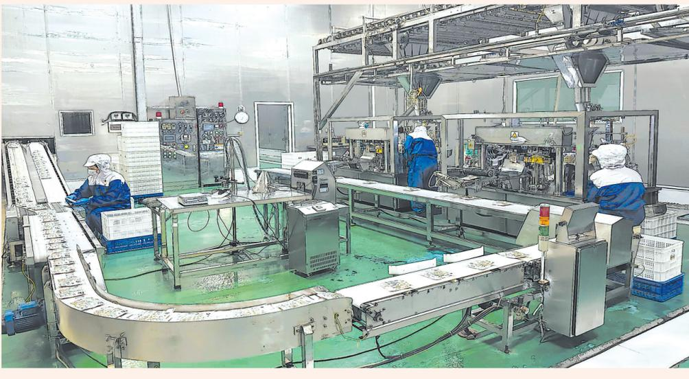
近日,在三明厨神食品有限公司生产车间内,经过调粉、压延、切条等多道工序,一根根粗细均匀的乌冬面从自动化生产线源源不断下线(右图)。
