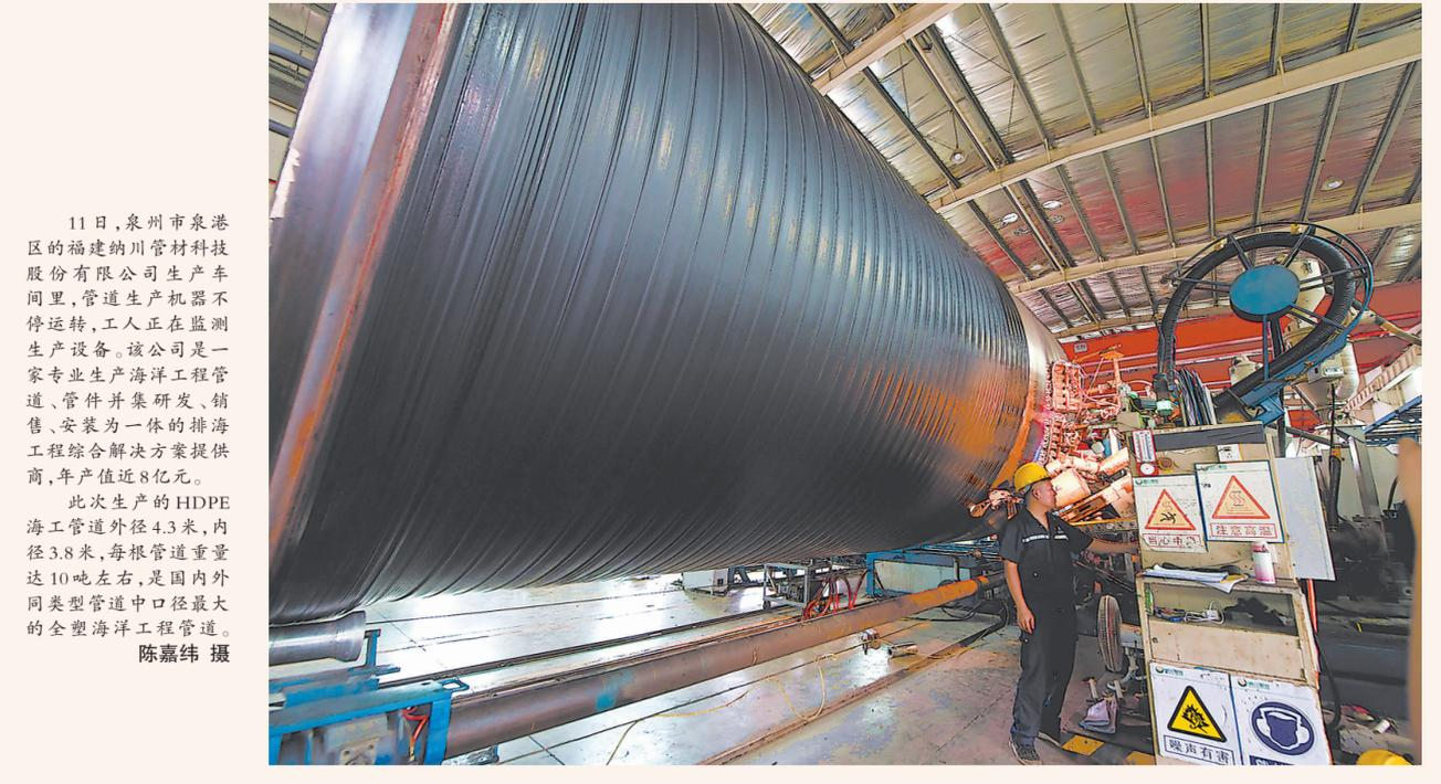
11日,泉州市泉港区的福建纳川管材科技股份有限公司生产车间里,管道生产机器不停运转,工人正在监测生产设备。该公司是一家专业生产海洋工程管道、管件并集研发、销售、安装为一体的排海工程综合解决方案提供商,年产值近8亿元。此次生产的HDPE海工管道外径4.3米,内径3.8米,每根管道重量达10吨左右,是国内外同类型管道中口径最大的全塑海洋工程管道。陈嘉伟 摄
