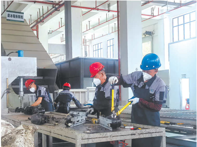
工人在拆解废旧冰箱的压缩机。
