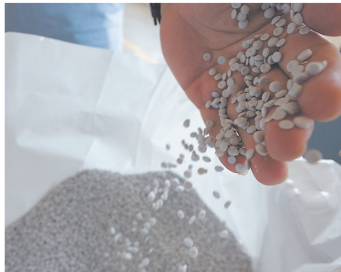
冰箱、洗衣机的塑料部件,经过处理后成为灰色的再生塑料颗粒。
