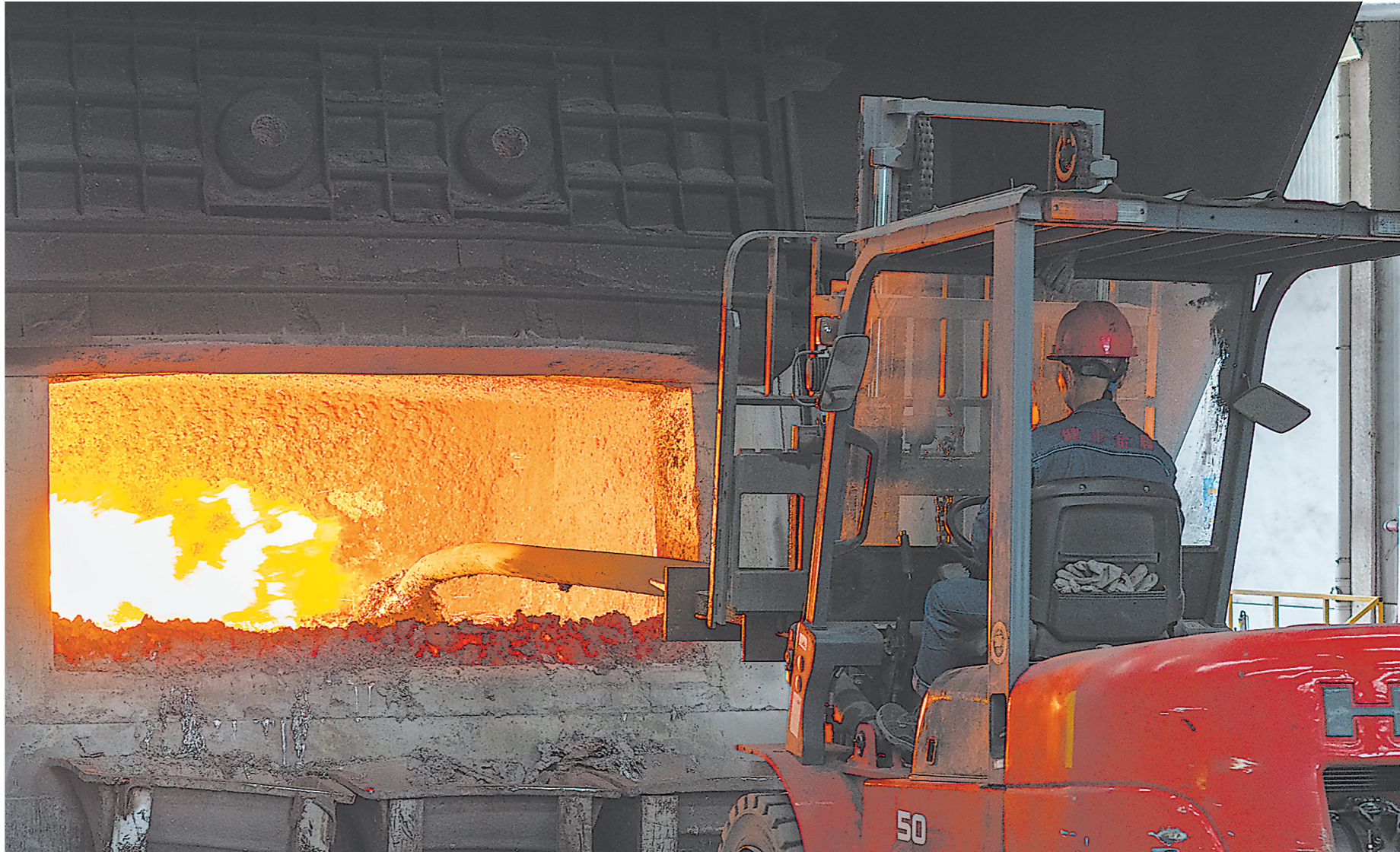
回收的铝部件,进入海西再生资源产业园区一家金属回收企业的熔炉重炼。
