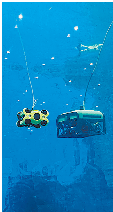
中海创新实验室研制的水下视觉探测机器人、水下声呐探测机器人等装置 (受访单位供图)
