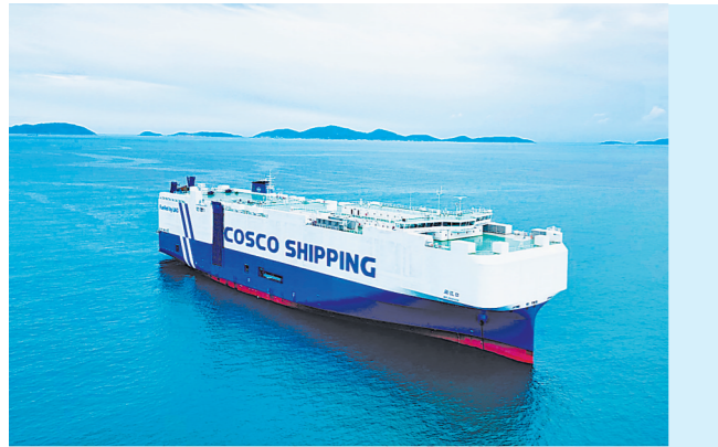
马尾造船厂自主建造的7500车位LNG双燃料汽车滚装船 (受访单位供图)
